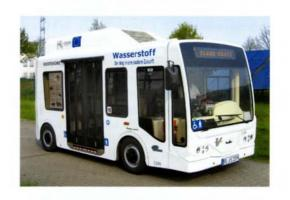
"Die neuen Busse werden für saubere Luft und ein besseres Stadtklima sorgen. Die Brennstoffzellenbusse fahren zu 100 Prozent schadstofffrei und besonders geräuscharm. Auf kleinstem Raum wurde auf dem Dach der gesamte Brennstoffzellenantrieb untergebracht", nannte Bürgermeister Ulrich Roland die ökologischen Vorzüge des Busses. Mit einer Tankfüllung von etwa sechs Kilo Wasserstoff erreichen die Hybridfahrzeuge zur Zeit eine Reichweite von rund 200 km.
